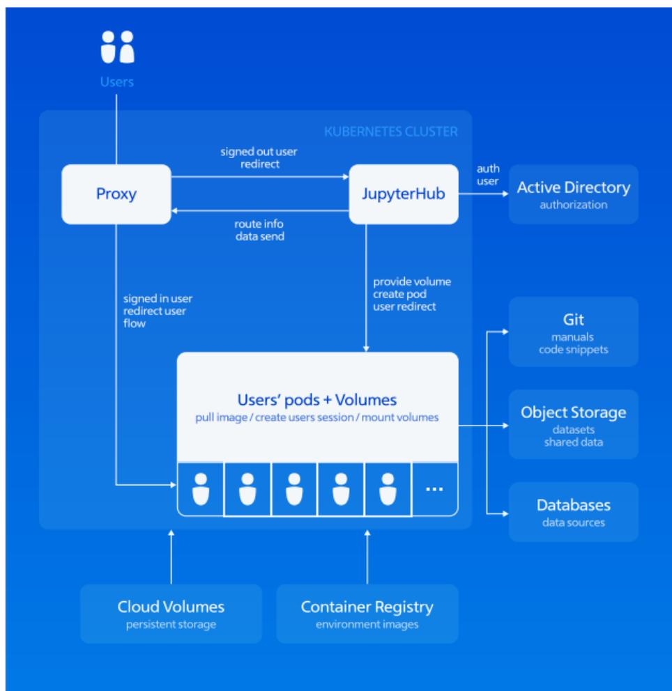
**Рис. 2.** Принципиальная архитектурная схема решения
